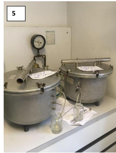
1 & 2: Beispielprofile im Wald. 3 & 4: pF-Kurve (Wasserretention) über Unterdruck und Filterbett. 5: Drucktöpfe für pF-Kurve (Wasserretention) über Überdruck.
